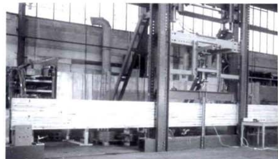
Traglastversuch im Rahmen eines Forschungsvorhabens an der Bauakademie der DDR zum Einfluss einer Verstärkung von Brettschichtholz mit glasfaserverstärkten Kunststoffen (GUP-Einlagen) auf die Biegefestigkeit, (Trägerhöhe: 608 mm)
