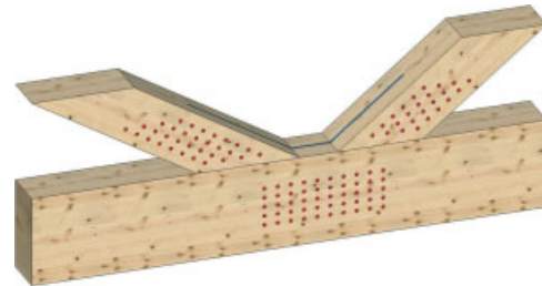
Bild 15. Ansicht des Fachwerkknotens Fig. 15. View of the truss joint
