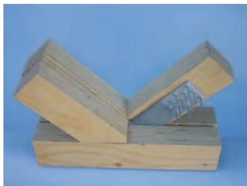
Abbildung 6.24: Multi- Krallendübel als Verbindungsmittel zwischen Kerto- Stäben
