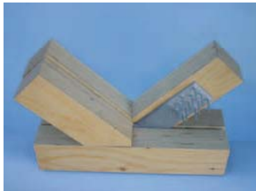
Abbildung 6.24: Multi- Krallendübel als Verbindungsmittel zwischen Kerto- Stäben
