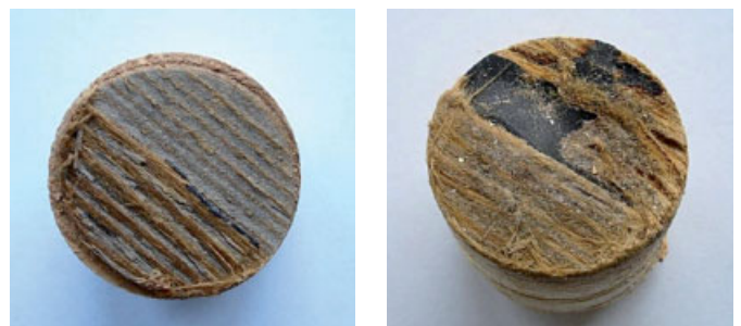
Bild 9. Typische Holzkorrosionserscheinungen an den Außenflächen Fig. 9. Typical wooden corrosion phenomena in the exterior surfaces
